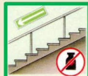
Не храните под лестницами горючие материалы
